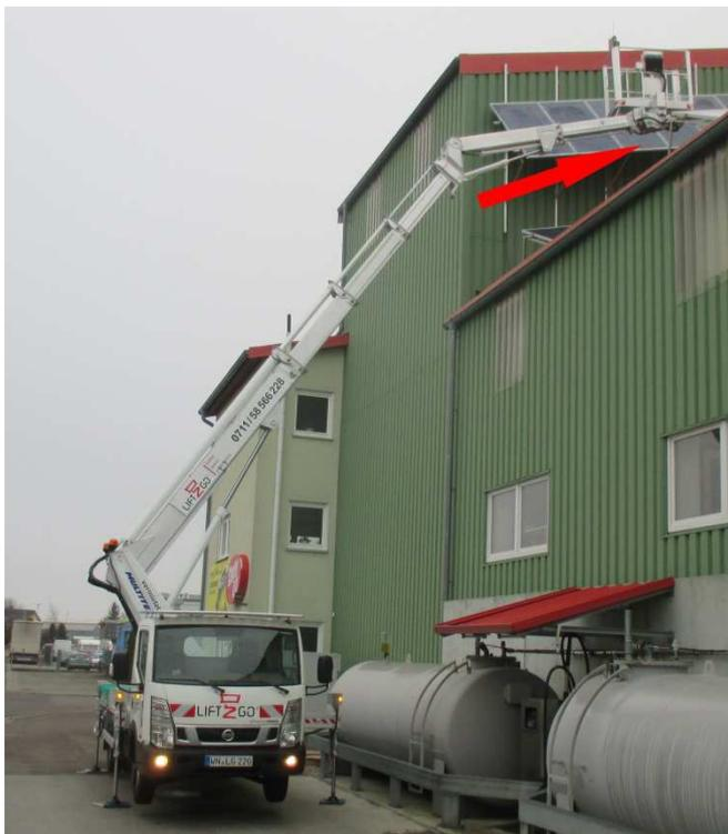
**Besonderheiten:** extra langer austeleskopierbarer Korbbarm | variable Abstützbreiten | 1000 V Isolation | Korbschwenkeinrichtung | Aufstellautomatik | Homefunktion | 250 kg Korblast |
